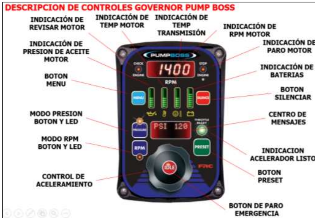
Figura 36. Gobernador de presión y monitor de motor, modelo PBA400
