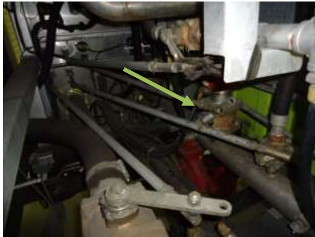
Figura 20. Bomba centrífuga Darley HM500, de 500 GPM
