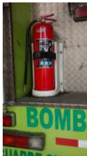
Figura 11. Extintor de PQS (polvo químico seco)
