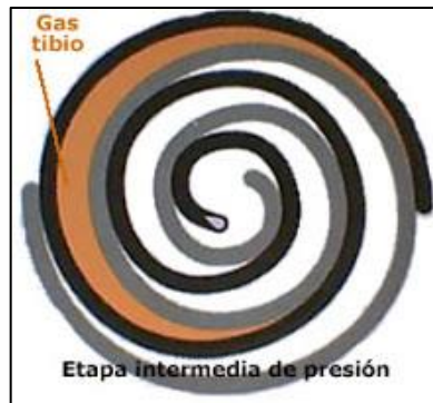
Figura 20. Compresión de refrigerante la entrada del paso de gas se sella por la espiral
