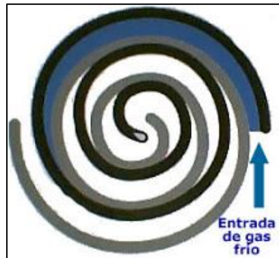
Figura 19. Aspiración de gas refrigerante en un compresor scroll
