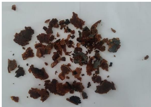
Figura 36. Degradación del plato desechable a los 80 días
