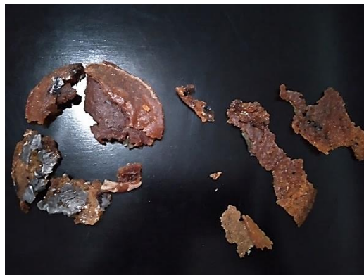
Figura 34. Degradación del plato desechable a los 40 días
