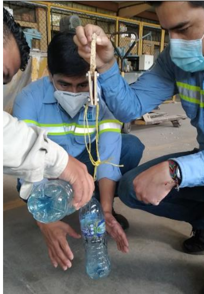
Figura 6. Ensayo de resistencia a la tracción a las probetas tipo III
