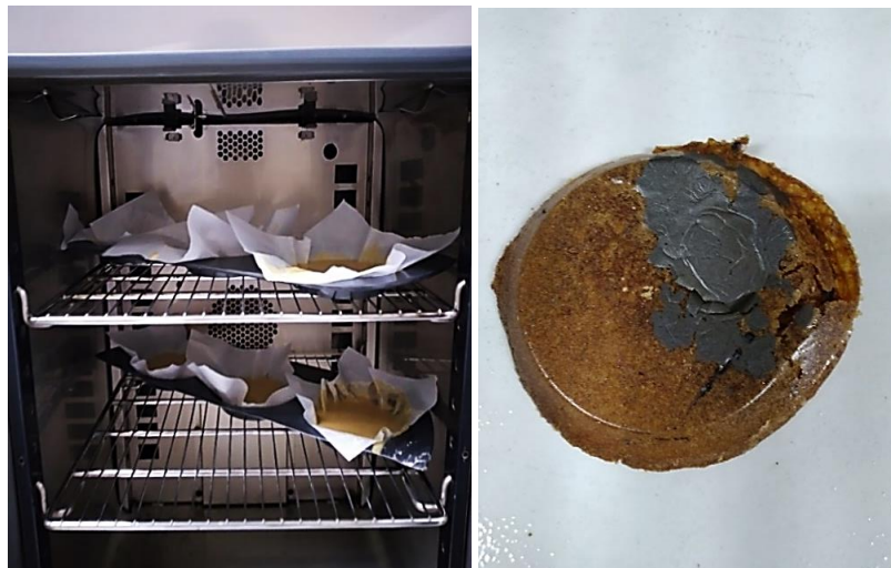
Figura 21. Proceso de formado utilizando un horno de convección
