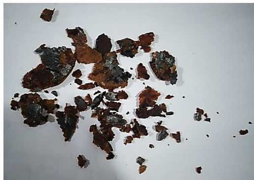
Figura 35. Degradación del plato desechable a los 60 días
