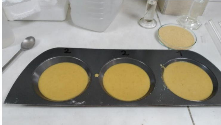
Figura 2. Vertido de mezclas en moldes para el proceso de formado en Experimentación fase 1
