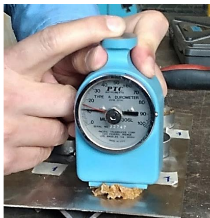
Figura 27. Ensayo de dureza de Shore A
