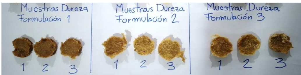
Figura 26. Muestras para realizar el ensayo de dureza de Shore
