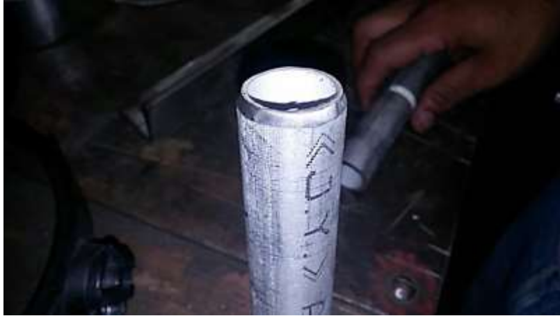
Figura 18. Biselado de las piezas a soldar
