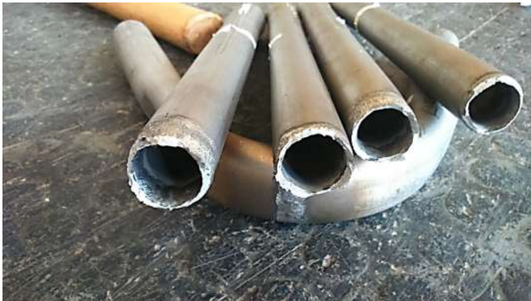
Figura 24. Falla por rotura de la soldadura en las probetas
