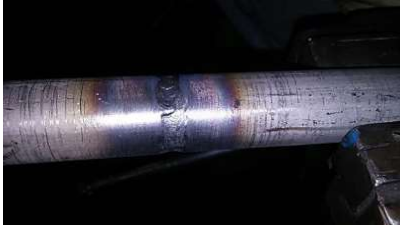
Figura 21. Cordón de soldadura por proceso TIG
