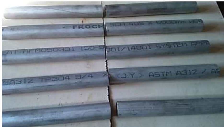
Figura 17. Corte de las probetas de ensayo ASTM A312, AISI 304
