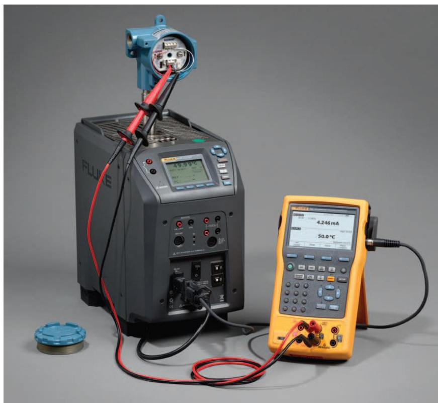
Figura 2. Equipo para calibración de termopares
