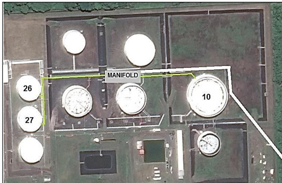
Figura 26. Distribución de diésel hacia los tanques de almacenamiento a través del Manifold de recepción
