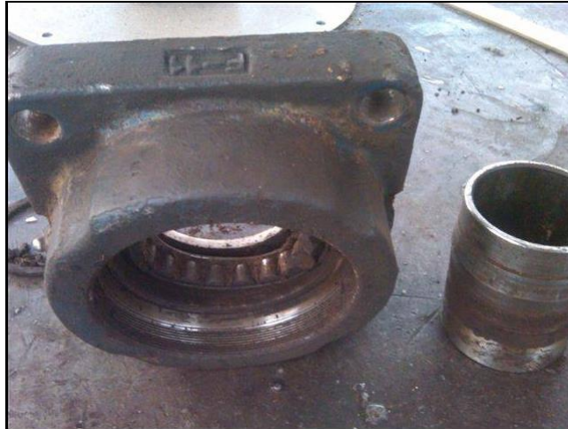
Figura 15. Chumacera con problemas de lubricación
