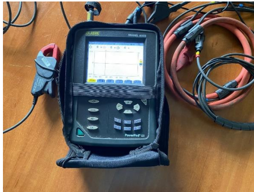
Figura 1. Medidor de calidad de energía AEMC
