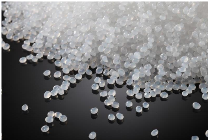
Figura 12. Polietileno de baja densidad
