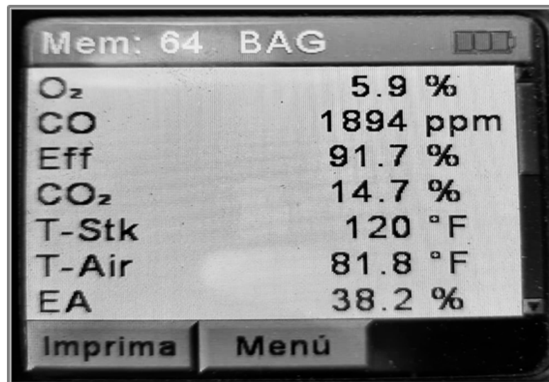
Figura 21. Medición de gases del analizador Bacharach
