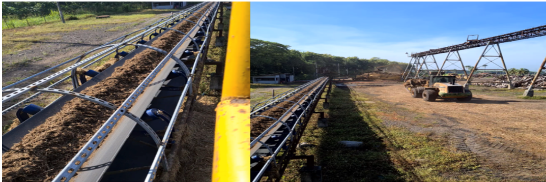
Figura 14. Proceso de alimentación de bambú chipeado
