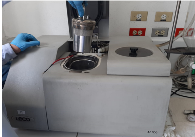
Figura 10. Análisis de poder calorífico en equipo AC500
