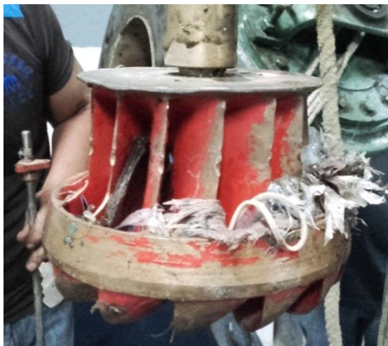
Figura 15. Rodete en malas condiciones
