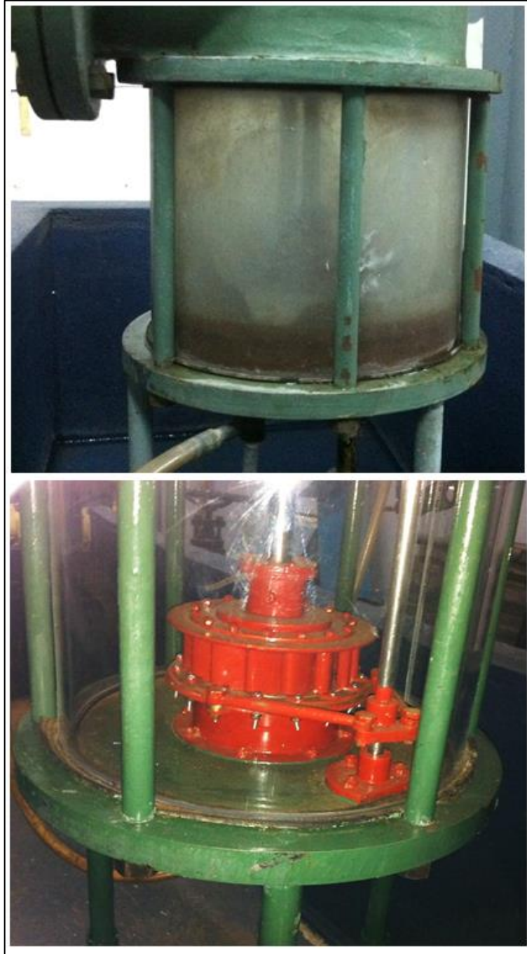
Figura 36. Reemplazo de vidrio por plexiglas
