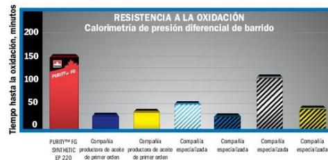
La resistencia más fuerte de los fluidos EP sintéticos PURITY FG SYNTHETIC al daño oxidativo ayuda a mantener las cajas de engranaje libres de lodos y de barniz y puede ampliar la vida útil del fluido y sus intervalos de cambio.
