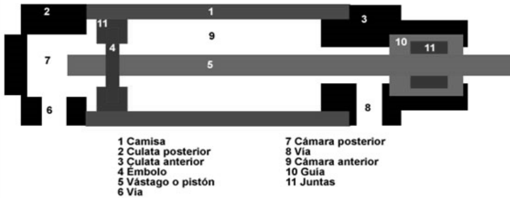
Figura 42. Cilindro neumático
