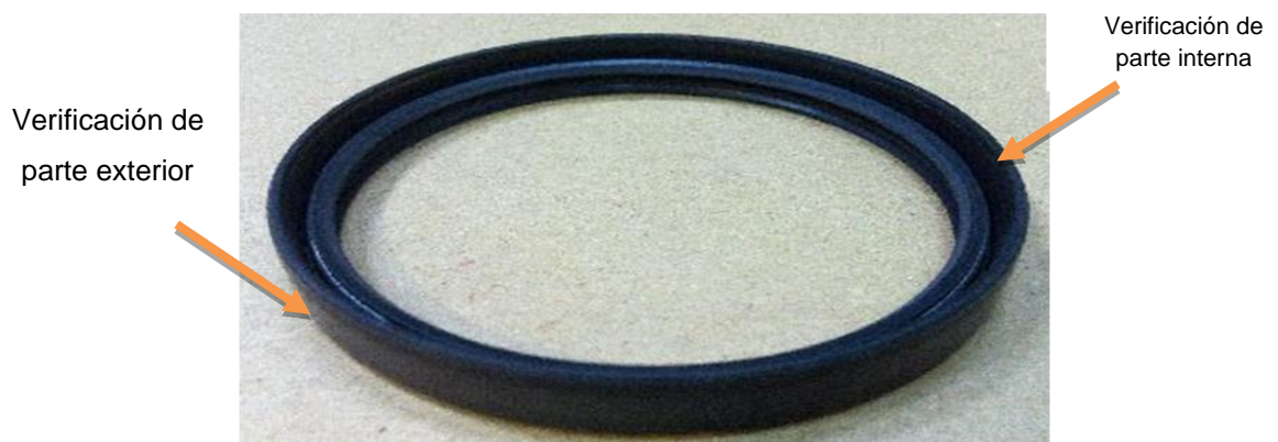
Figura 29. Inspección de retenedor
