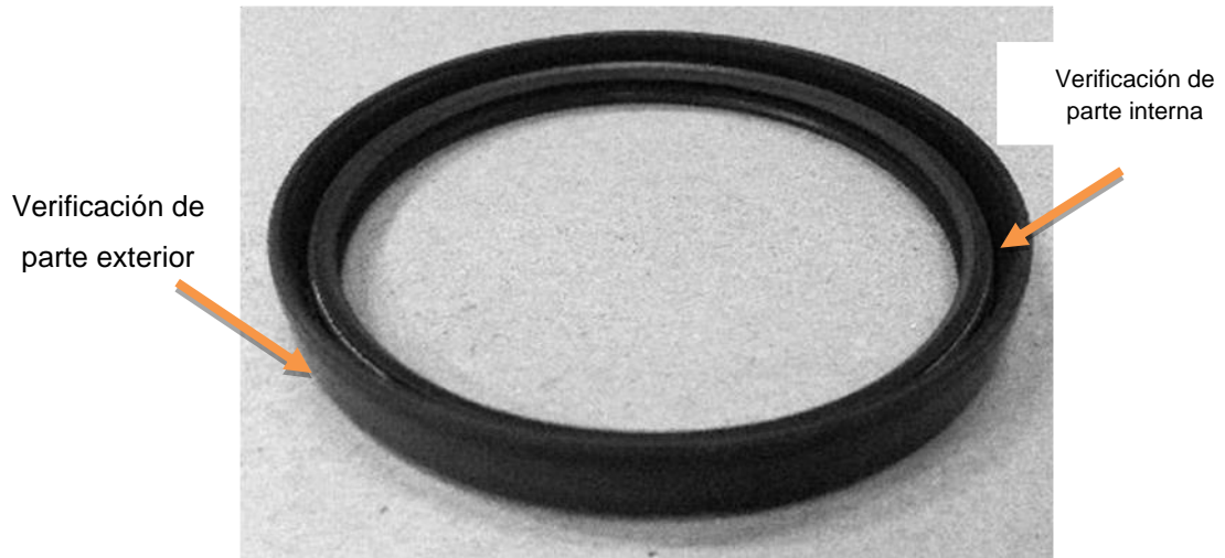
Figura 34. Inspección de retenedor de la VCO-5
