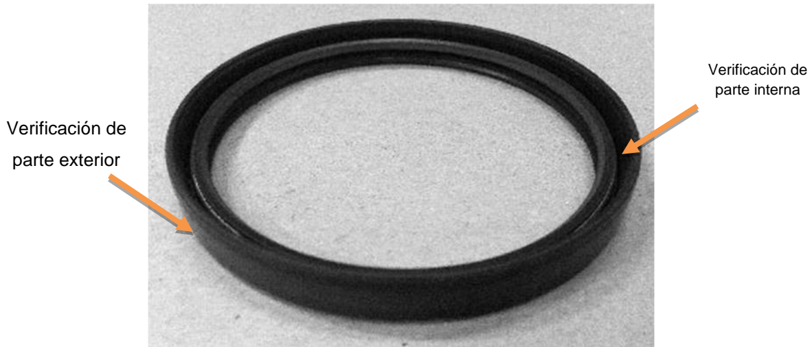
Figura 36. Inspección de retenedor de la máquina IFC-1
