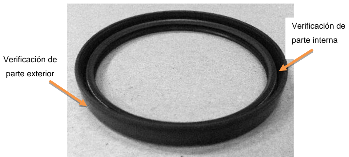
Figura 9. Inspección de empaque de cilindro
