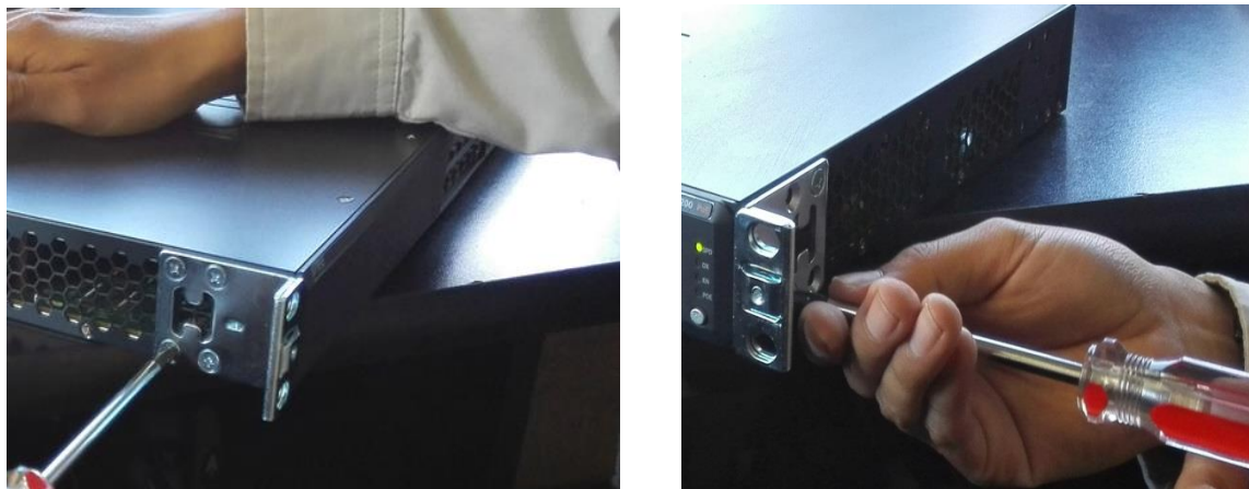
Figura 20. Instalación de kit para montaje en bastidor
