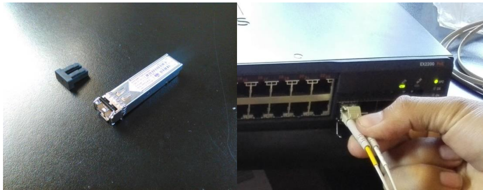
Figura 21. Instalación de módulo Gbic, puerto ge-0/1/0
