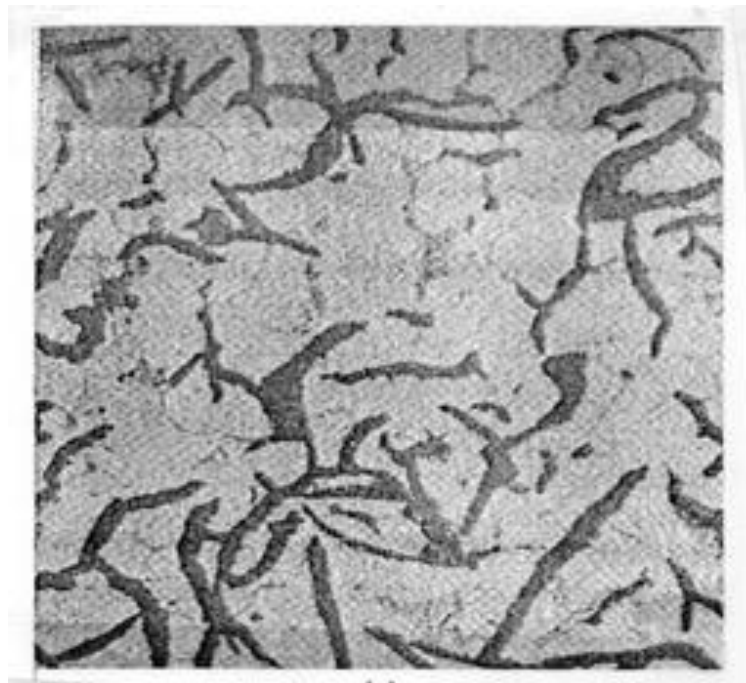
Figura 4. Microestructura fundición gris ferrítica
