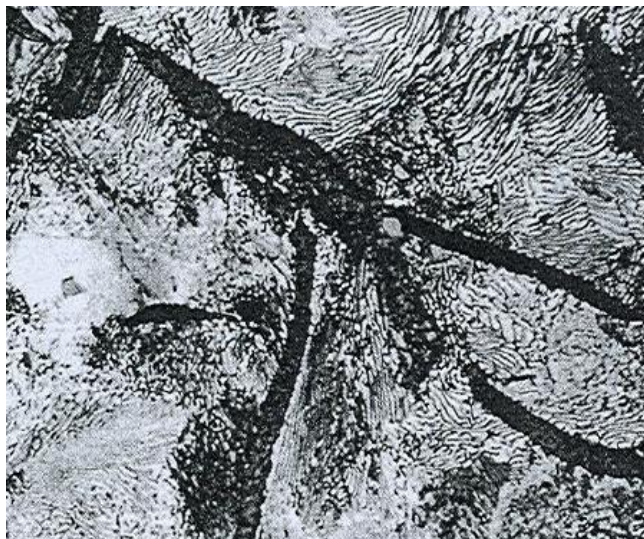
Figura 6. Microestructura fundición gris perlítica/ferrítica
