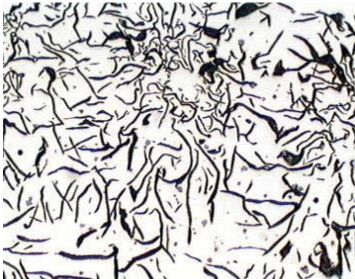
Figura 2. Microestructura fundición gris
