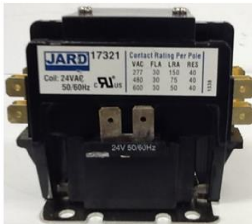
b) Esquema real / contactor para aire acondicionado con bobina 24 V
