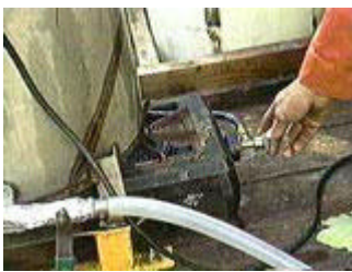
Figura # 7 Quemador bajo la vasija de transesterificaciòn
