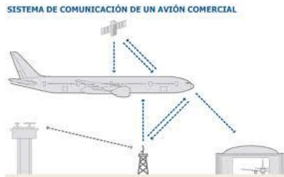
Figura 37. El tipo de mensajes que se transmiten son mensajes digitales, en la frecuencia VHF (129 MHz a 137 MHz)
