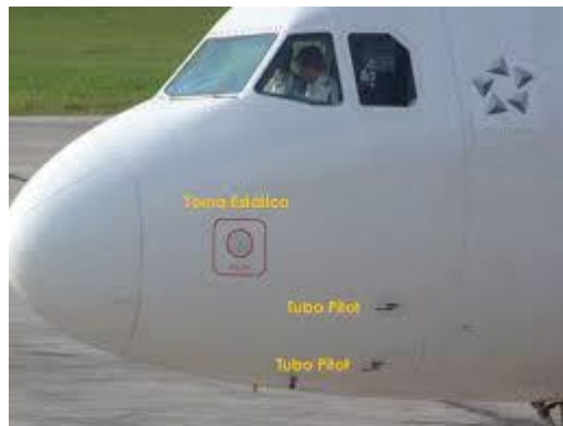
Figura 22. Posición del tubo Pitot en el avión
