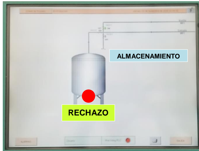
Figura 27. Sinóptico de almacenamiento, agua para inyección
