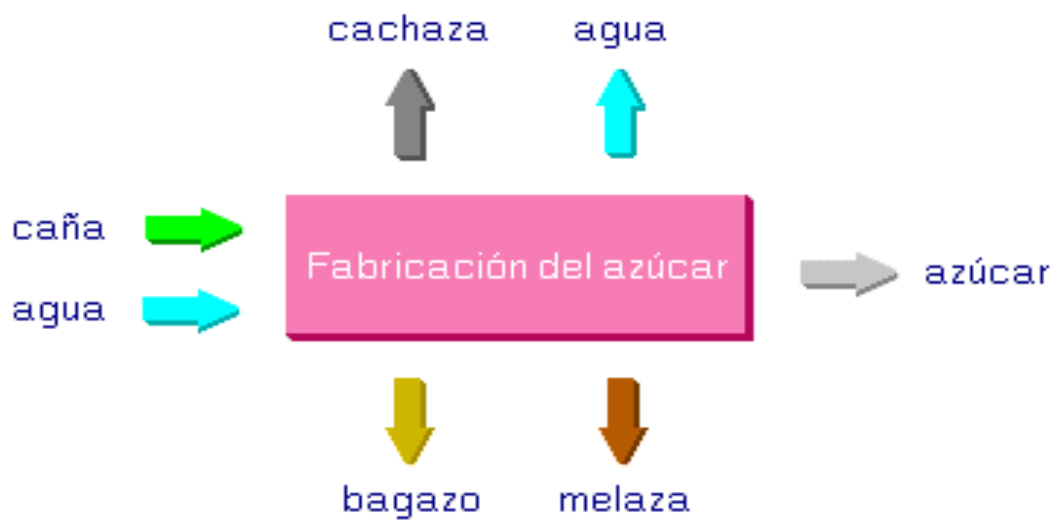
Figura 1. Diagrama simplificado del proceso de fabricación de azúcar
