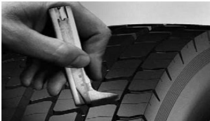
Figura 39. Medición de la profundidad del neumático
