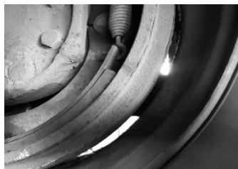
Figura 1. Inspección visual de frenos
