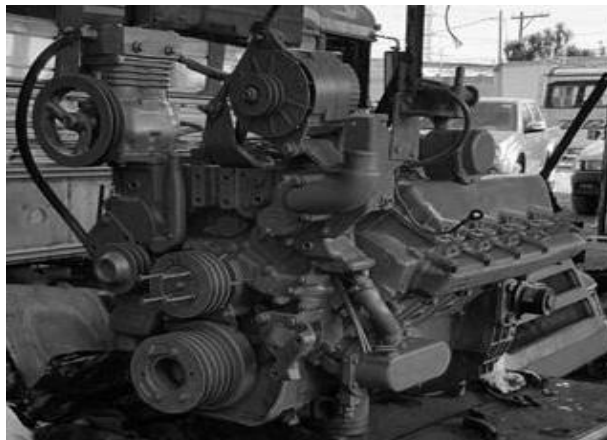
Figura 11. Motor Caterpillar 3208 Turbo sobre banco de trabajo
