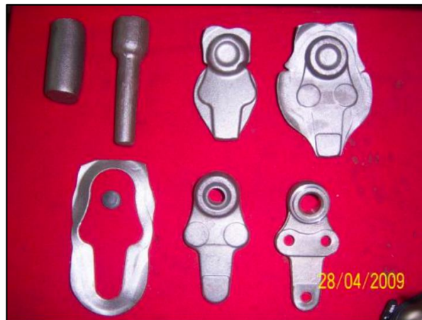
Figura 2. Ejemplo pieza realizada por forjado
