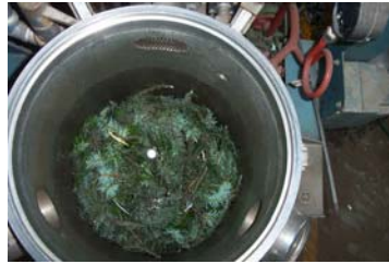
Figura 7. Distribución de la materia prima en los platos dentro del macerador
