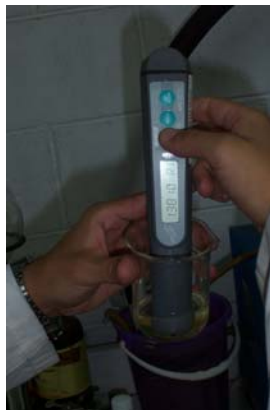
Figura 27. Caracterización del aceite. Determinación del índice de refracción
