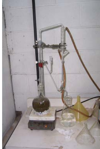
Figura 25. Extracción por arrastre de vapor de aceite esencial de pinabete a nivel laboratorio, por medio de un neoclavenger
