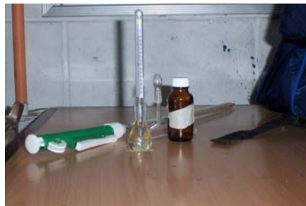
Figura 26. Caracterización del aceite. Determinación de la densidad
