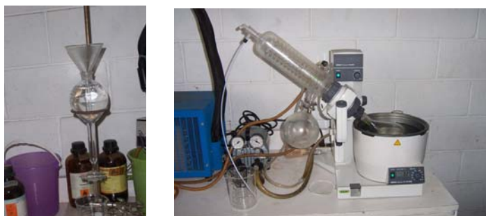
Figura 11. Decantación y separación del aceite esencial crudo del hexano
