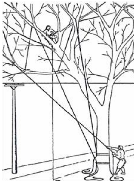
Figura 30. Como colocar los lazos para cortar una rama grande
