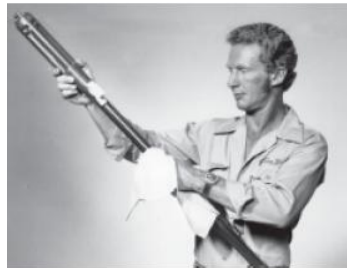
Figura 54. Limpieza de equipo para líneas vivas
