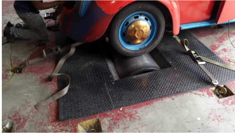
Figura 5. Prueba de dinamómetro a motor de 1 300 cc
