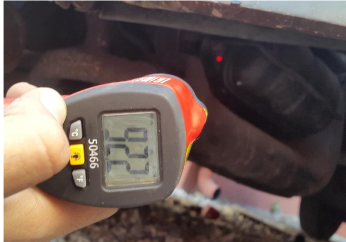
Figura 38. Temperatura de la cabeza derecha de cilindros
