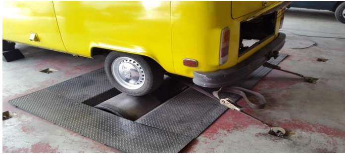
Figura 27. Prueba de dinamómetro a motor de 1 600 cc
