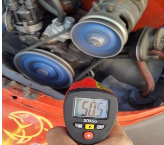
Figura 36. Temperatura del bloque del motor
