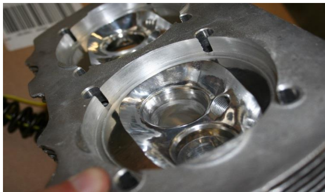
Figura 17. Mecanizado en cabeza de cilindros
