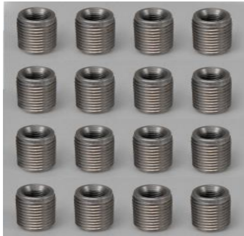
Figura 24. Case savers del bloque del motor
