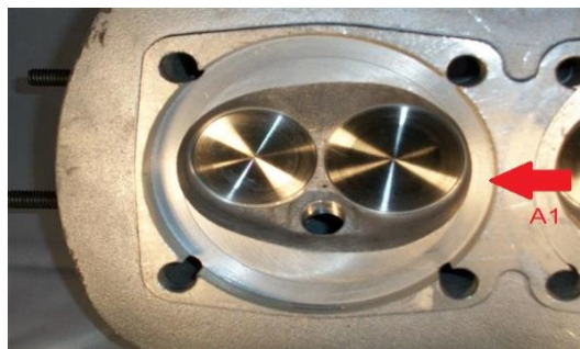
Figura 19. Área de corona circular en cabeza de cilindros
