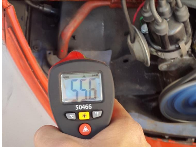
Figura 40. Temperatura de tubería izquierda de recirculación de gases de escape
