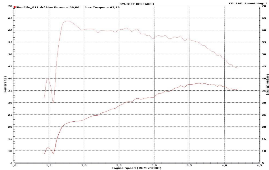
Figura 29. Diagrama final del motor de 1 600 cc, hp – RPM – torque
