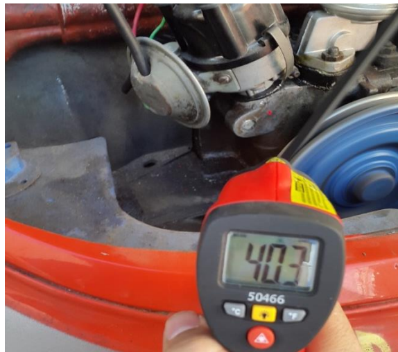
Figura 35. Temperatura base de distribuidor de chispa
