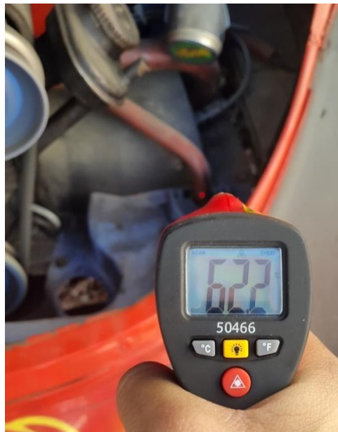
Figura 39. Temperatura de tubería derecha de recirculación de gases de escape
