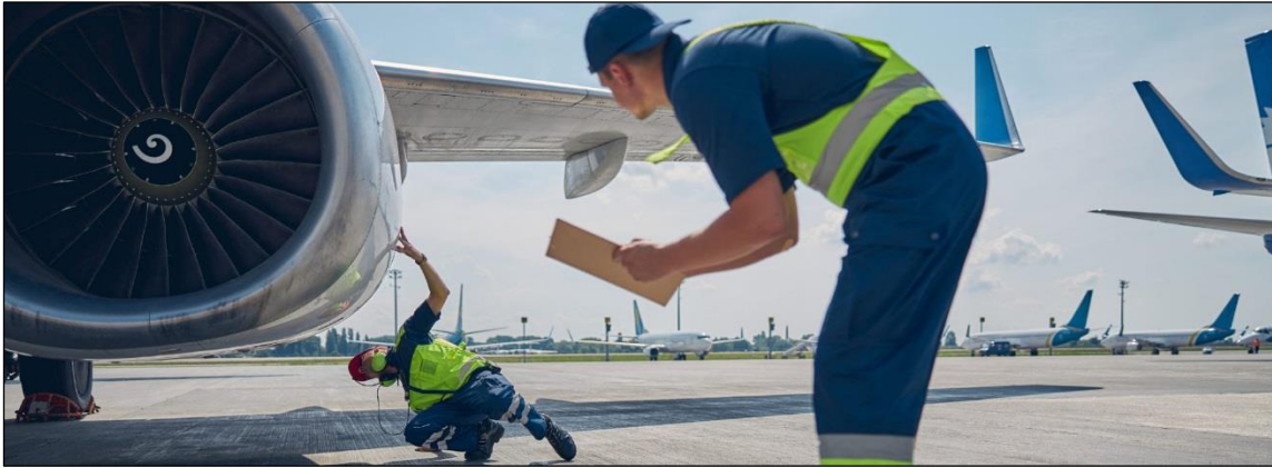
Figura 11. Inspección visual realizada en mantenimiento de línea
