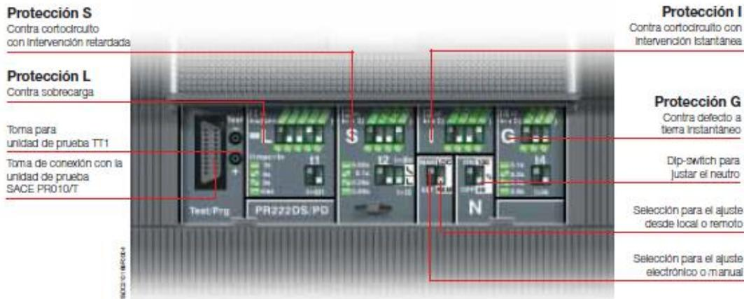
Fuente: *Catálogo técnico*. [www.renner.com.gt/catalogos.../abb/ABB-breaker-TMAX-caja-moldeada](http://www.renner.com.gt/catalogos.../abb/ABB-breaker-TMAX-caja-moldeada). p 2. Consulta: 10 de diciembre de 2015.
