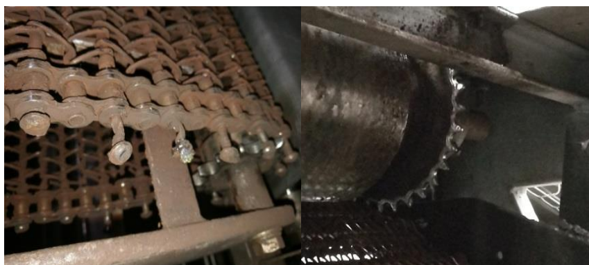
Figura 15. Desgaste en componentes de tracción
