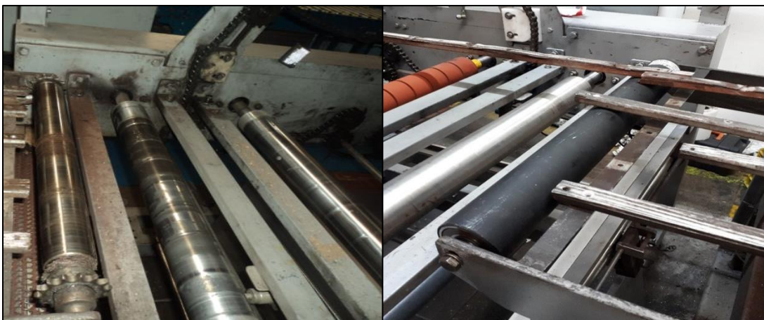
Figura 41. Comparación de los cambios realizados a los rodillos de entrada al horno
