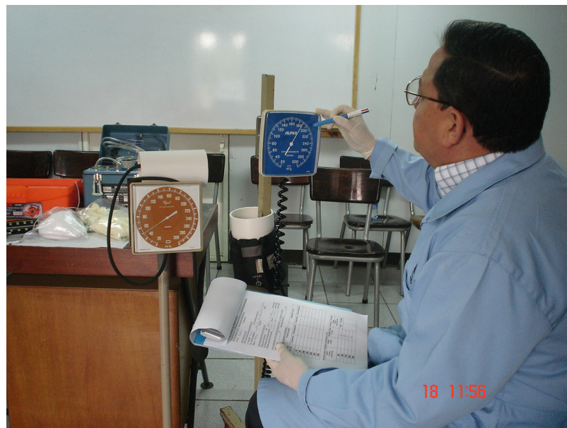
Figura 2. Calibración de esfigmomanómetros aneroides con rodos, en el Hospital Roosevelt.
