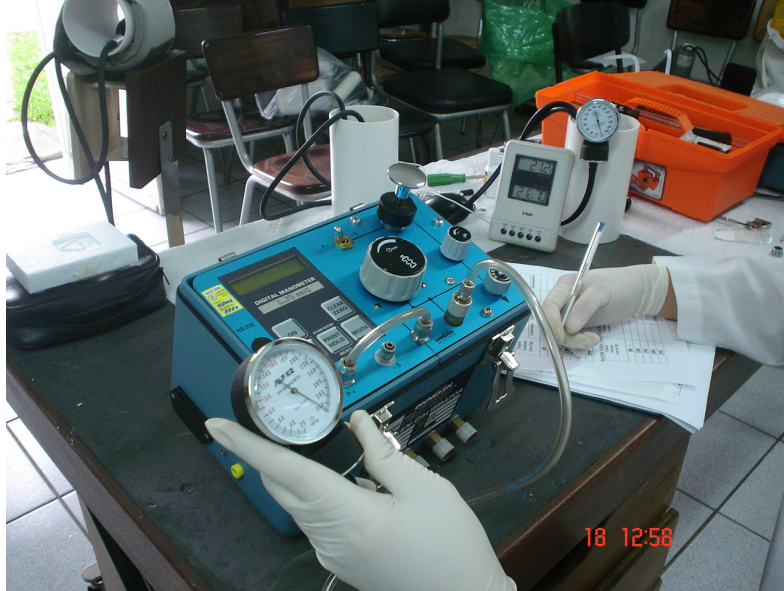
Figura 3. Calibración de esfigmomanómetros aneroides manuales en el Hospital Roosevelt.
