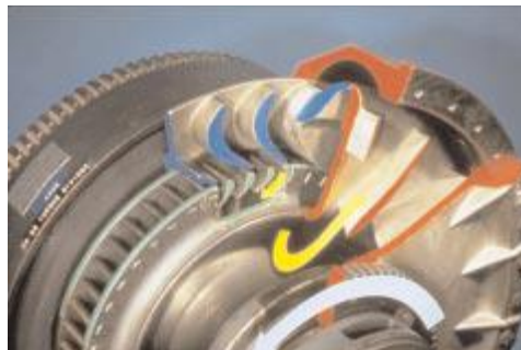
Figura 15. El estator dirige el aceite nuevamente al rodete
