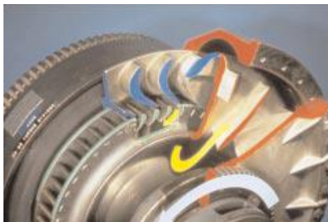
Figura 16. Dirección de flujo entre los componentes del convertidor
