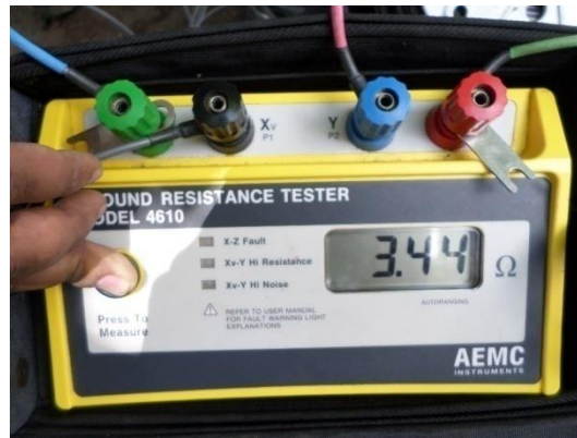
Figura 68. Equipo utilizado en la toma de resistencia a tierra
