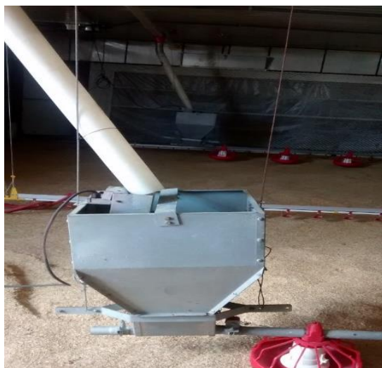
Figura 54. Tolvas recibidoras de alimento automatizadas
