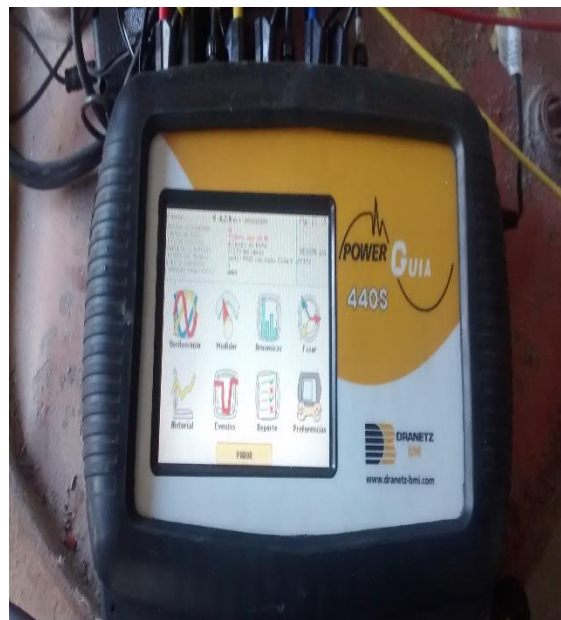
Figura 86. Equipo analizador de redes eléctricas 440S
