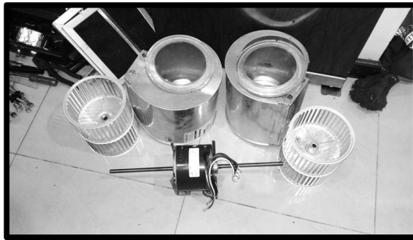
Figura 41. Cuerpo motor de la turbina desarmado
