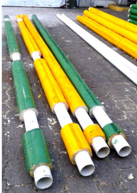
Figura 45. Aislamiento de tubería de PVC
