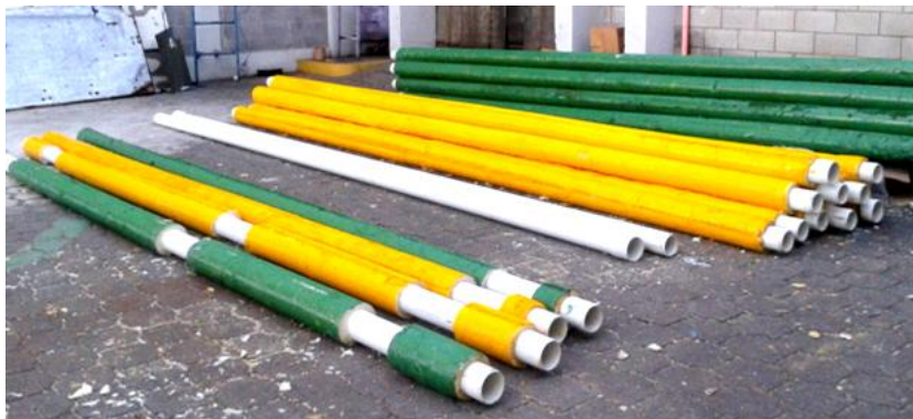
Figura 46. Aislamiento de tubería de PVC
