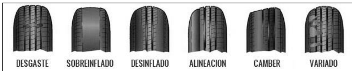
Figura 18. Desgaste de las llantas
