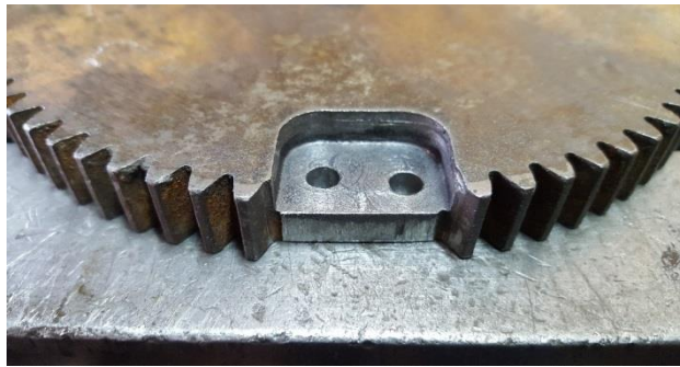
Figura 46. Fresado de cavidad para el injerto
