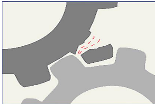
Figura 7. Desprendimiento total de un diente de una rueda dentada
