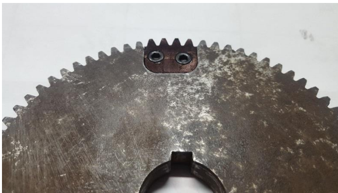
Figura 49. Reacondicionamiento de rueda dentada por aplicación de un injerto
