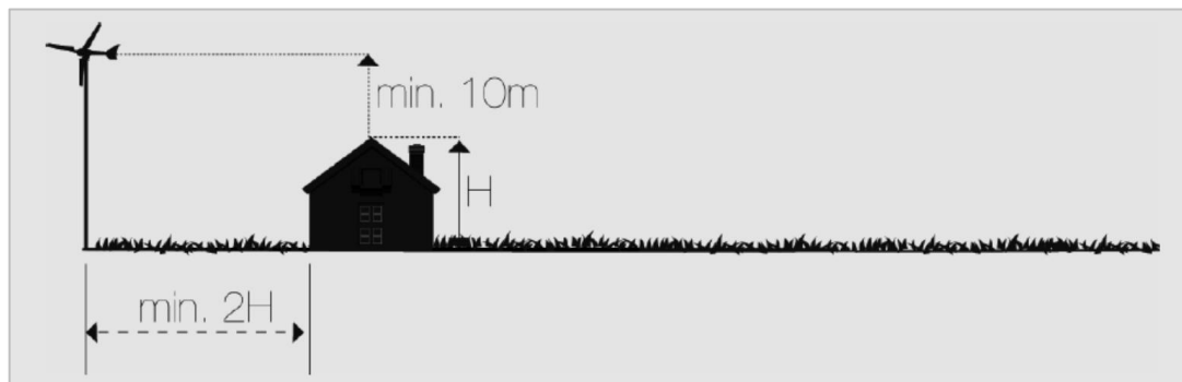
Figura 30. Ubicación de torre de aerogenerador
