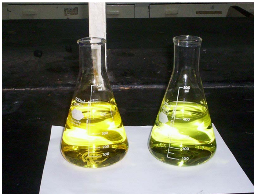
Figura 35. Finalización de la titulación con permanganato de potasio
