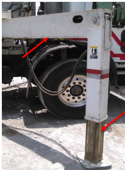
Figura 40. Superficie de lubricación de estabilizadores de la pluma
