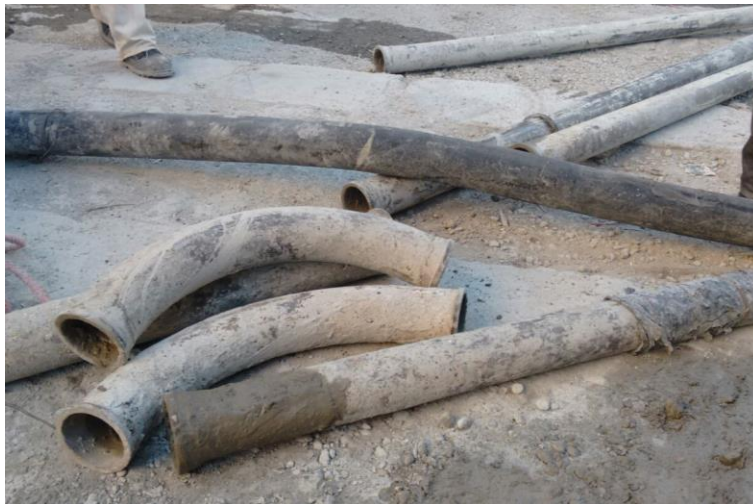
Figura 15. Tubería para transporte de concreto
