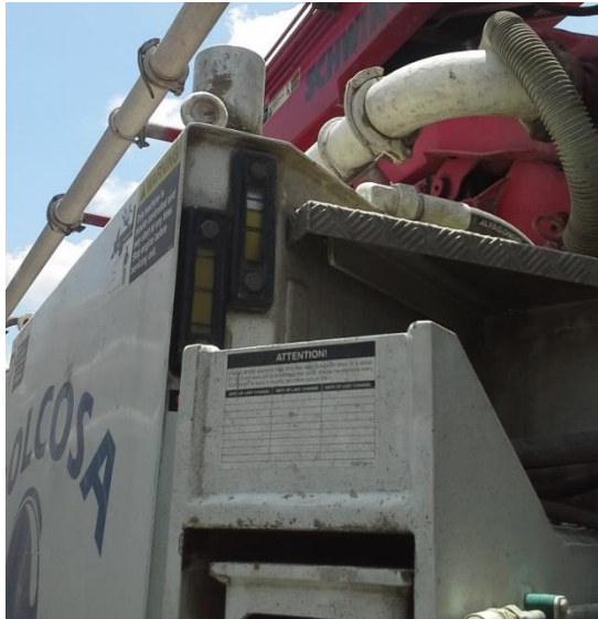
Figura 28. Nivel de aceite del tanque hidráulico
