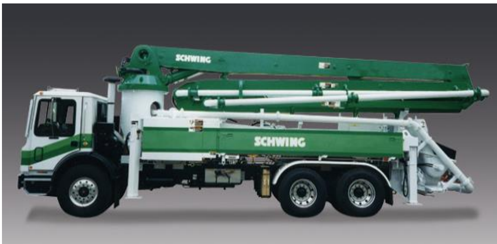
Figura 2. Bomba para concreto tipo pluma, montada en un camión
