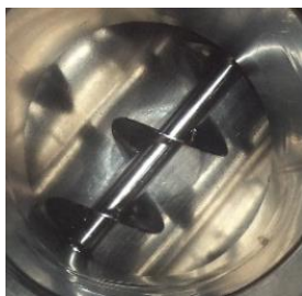
Figura 32. Tornillo sin-fin visto desde el interior de un embudo
