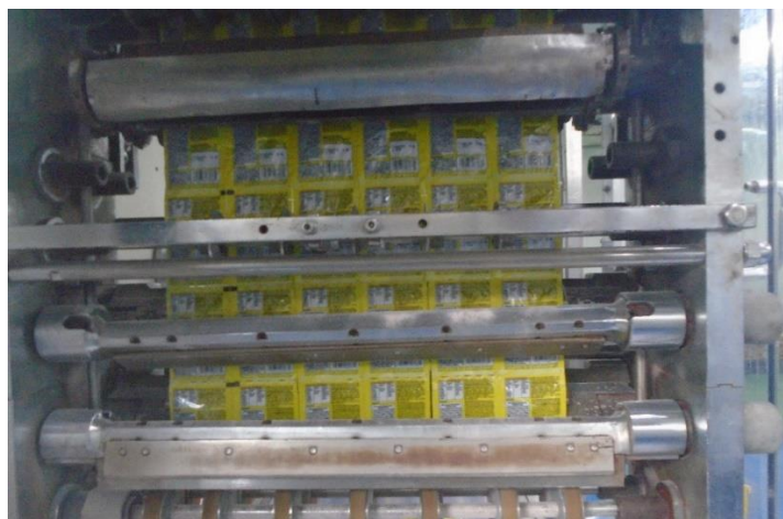
Figura 36. Acción de los rodillos de corte vertical y horizontal sobre el empaque dentro de la llenadora vertical
