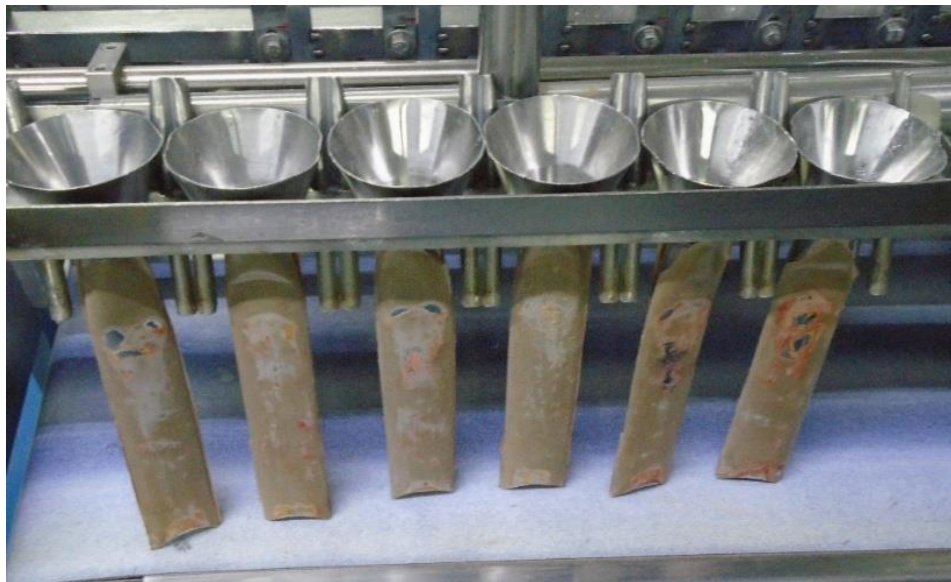
Figura 35. Embuditos de dosificación
