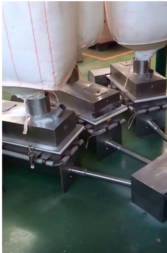
Figura 31. Disposición de tres embudos de alimentación monosabor
