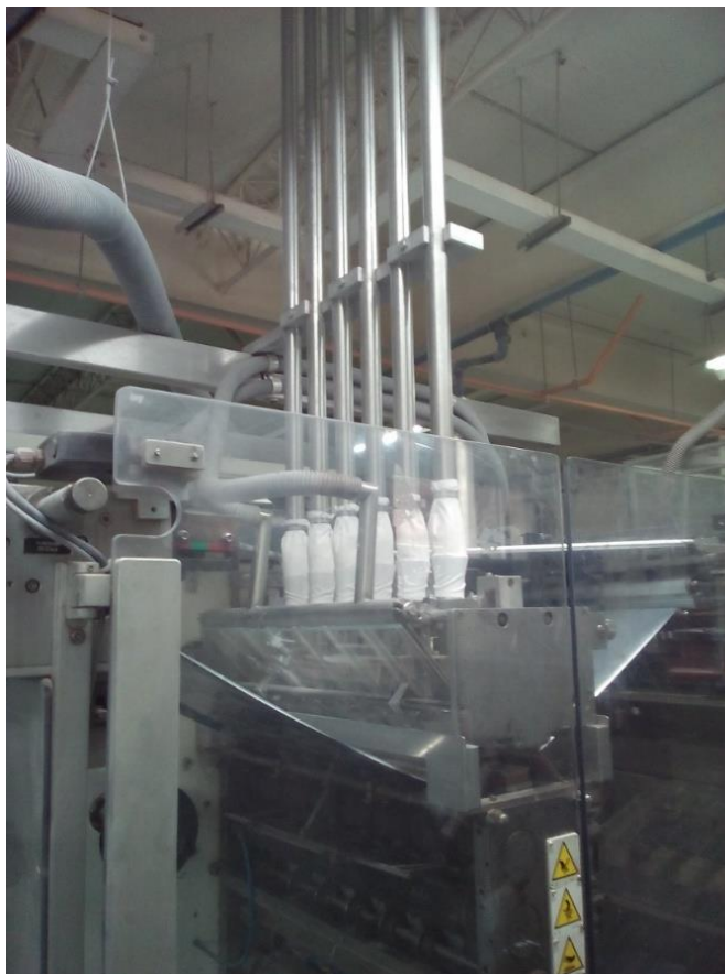
Figura 34. Disposición de los tubos de dosificación, transfiriendo producto desde el segundo nivel
