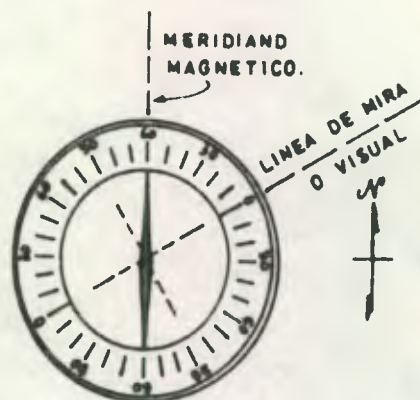
CARACTERISTICAS DE LA BRUJULA UTILIZADA EN TOPOGRAFIA.
