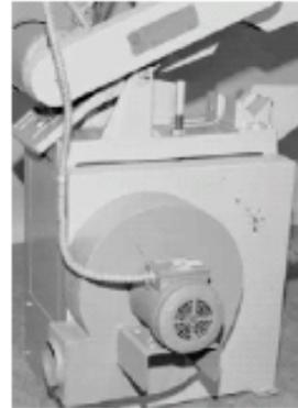
Está disponible un ventilador de humos monofásico que es perfectamente adaptable para el uso con las cortadoras de mangueras (estacionarias) 9U- 7319 & 9U-7320 a través de una solicitud especial.
