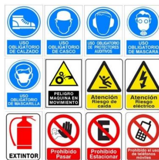
Figura 51. Señalización para identificación de riesgos
