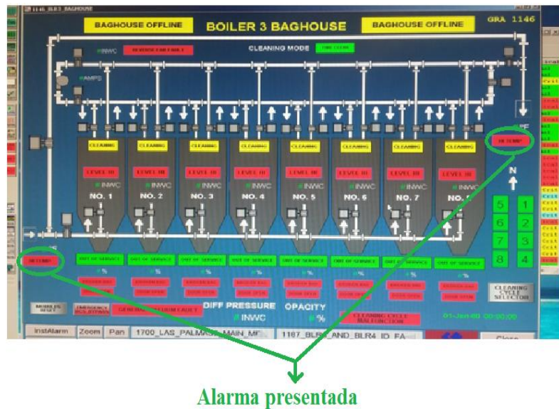
Figura 55. Mensaje desplegado HI TEMP
