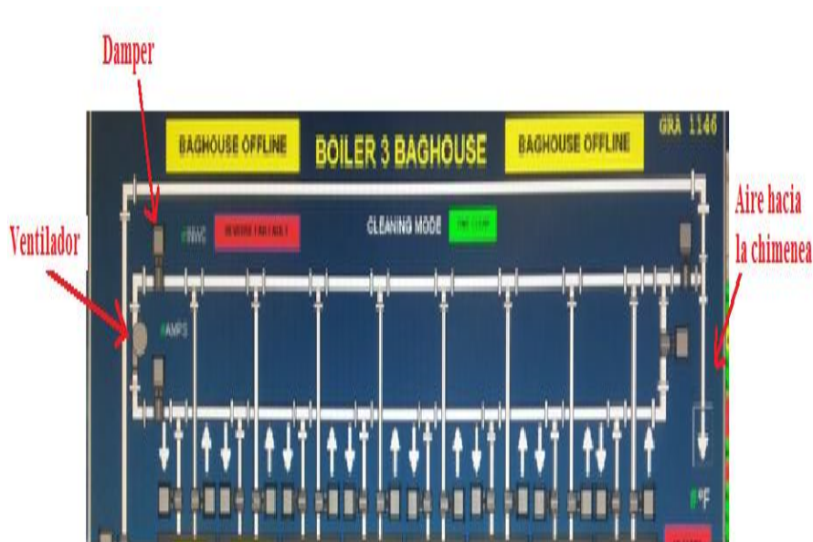
Figura 72. Ubicación del d mper y ventilador de aire reverso
