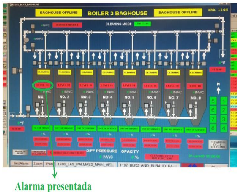
Figura 54. Mensaje desplegado LEVEL HI
