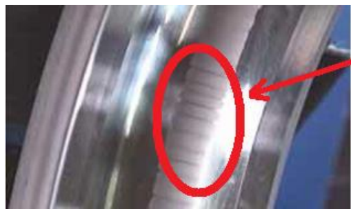
Figura 93. Surcos provocados por corrientes parasitas al usar un variador
