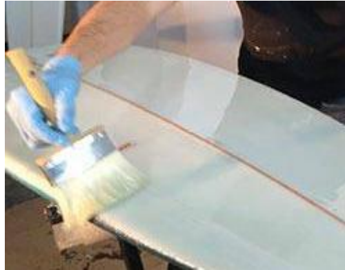
Figura 19. Aplicación de gelcoat
