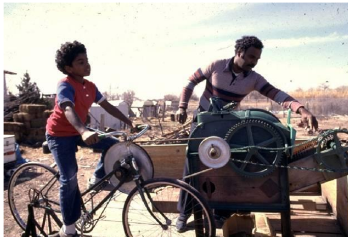
Figura 35. Prototipo de Dynapod conectado a desgranadora de maíz
