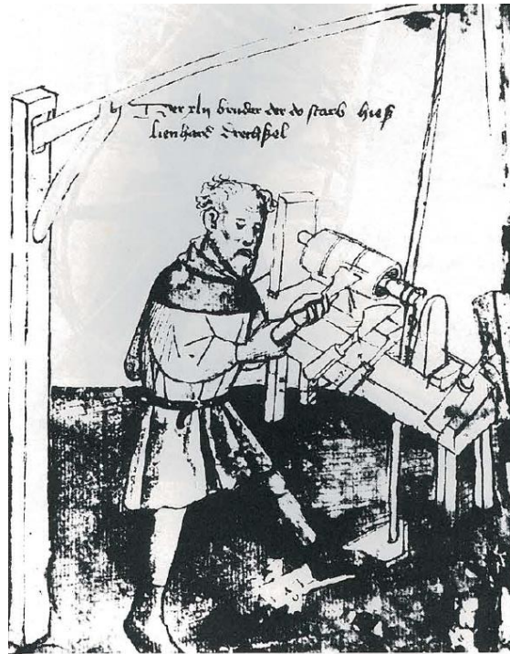
Figura 29. Esmeril accionado mediante pedal, mecanismo arco – cuerda
