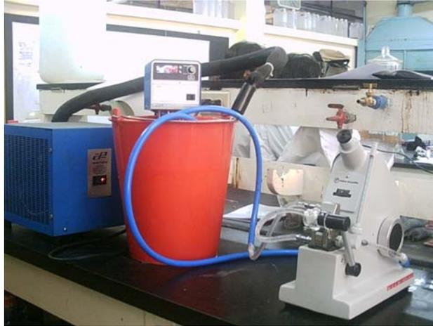
**Figura 18. Equipo y cristalería empleados para la titulación de las mezclas binarias**
