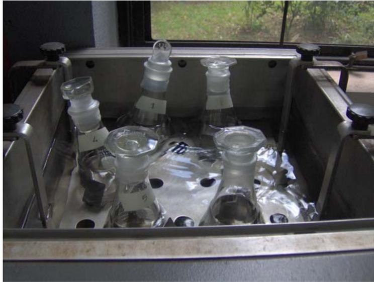
**Figura 20. Equipo y cristalería empleados para la separación de las fases luego de la agitación**
