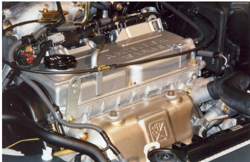
Figura 4. Motor de combustión interna ciclo de Otto Mitsubishi 4G94
