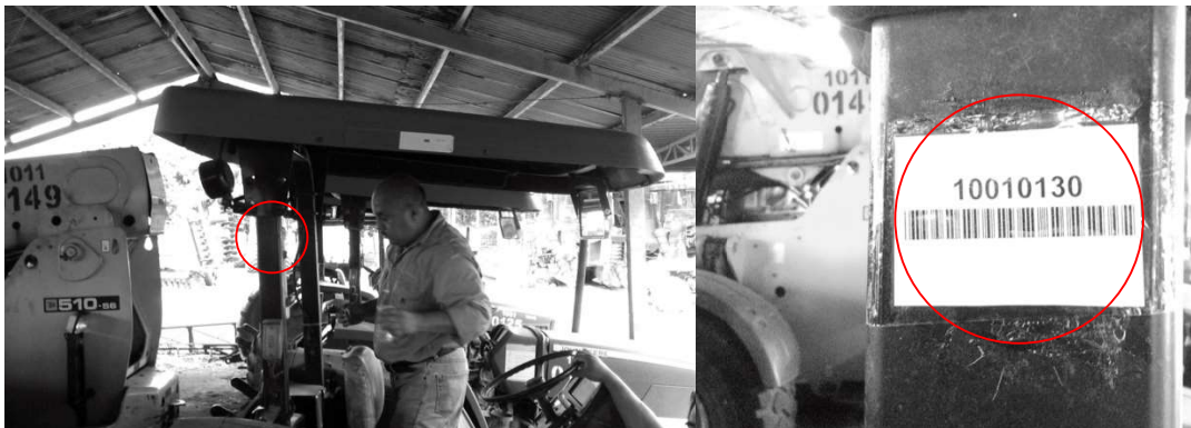
Figura 13. Instalación de chip NFC
