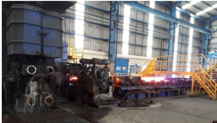
Figura 3. Inicio del proceso de laminación en caliente
