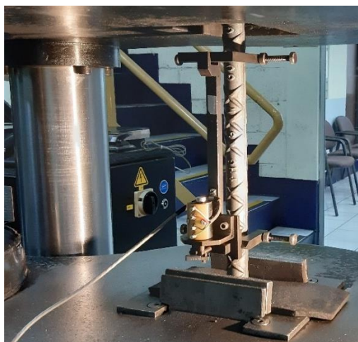
Figura 6. Varilla corrugada con extensómetro
