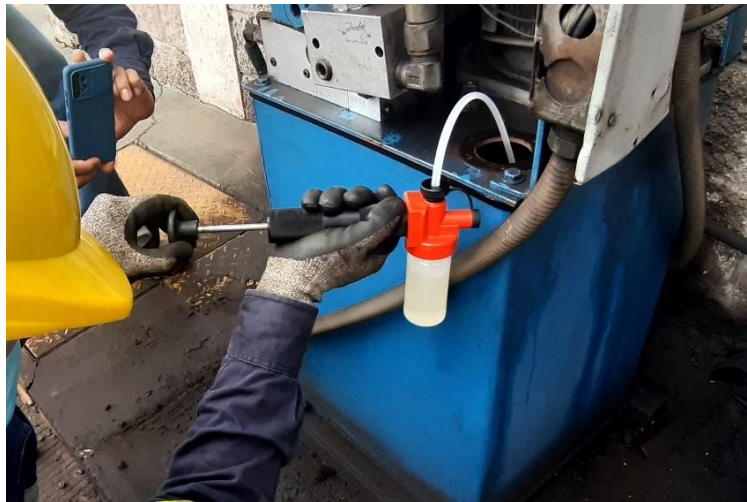
Figura 30. Toma de muestra de aceite con bomba de vacío manual
