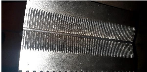
Figura 20. Desgaste por escoria en mordaza
