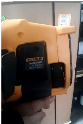
Figura 17. Equipo utilizado para pruebas de termografía
