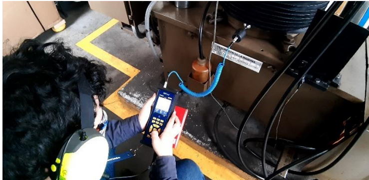
Figura 27. Ultrasonido realizado en cilindro hidráulico principal
