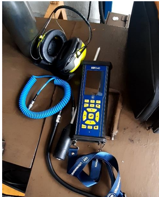
Figura 18. Equipo utilizado para pruebas de ultrasonido
