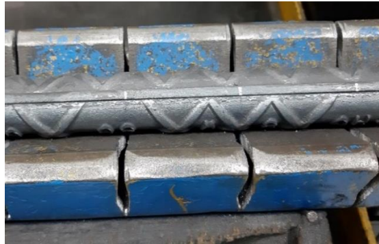
Figura 5. Marcaje de varilla corrugada cada 2 pulgadas
