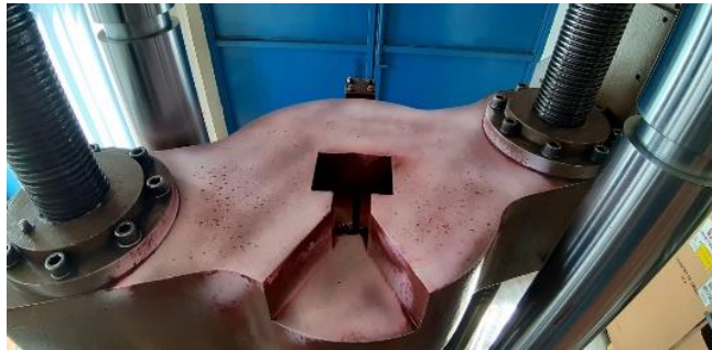
Figura 22. Líquidos penetrantes en cabezal inferior
