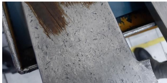
Figura 21. Desgaste por escoria en alza
