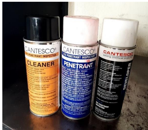
Figura 15. Kit de líquidos penetrantes usados para END
